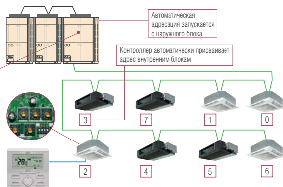
Адресацию также можно выполнять вручную на контроллере внутреннего блока или при помощи пульта ДУ
